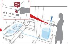
ノコリ~ユECO」にすればボタンを押すだけで残り 湯を洗濯機に移せます。
