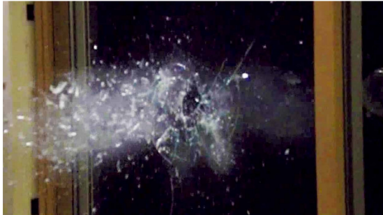
小石など小さな飛来物が衝突したときの様子 (複層ガラスに2gの鋼球が時速143kmで衝突)
