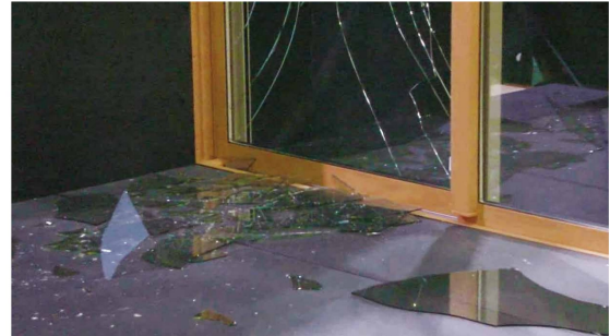
重い飛来物が衝突したときの様子 (複層ガラスに3kgの木材が時速44kmで衝突)
